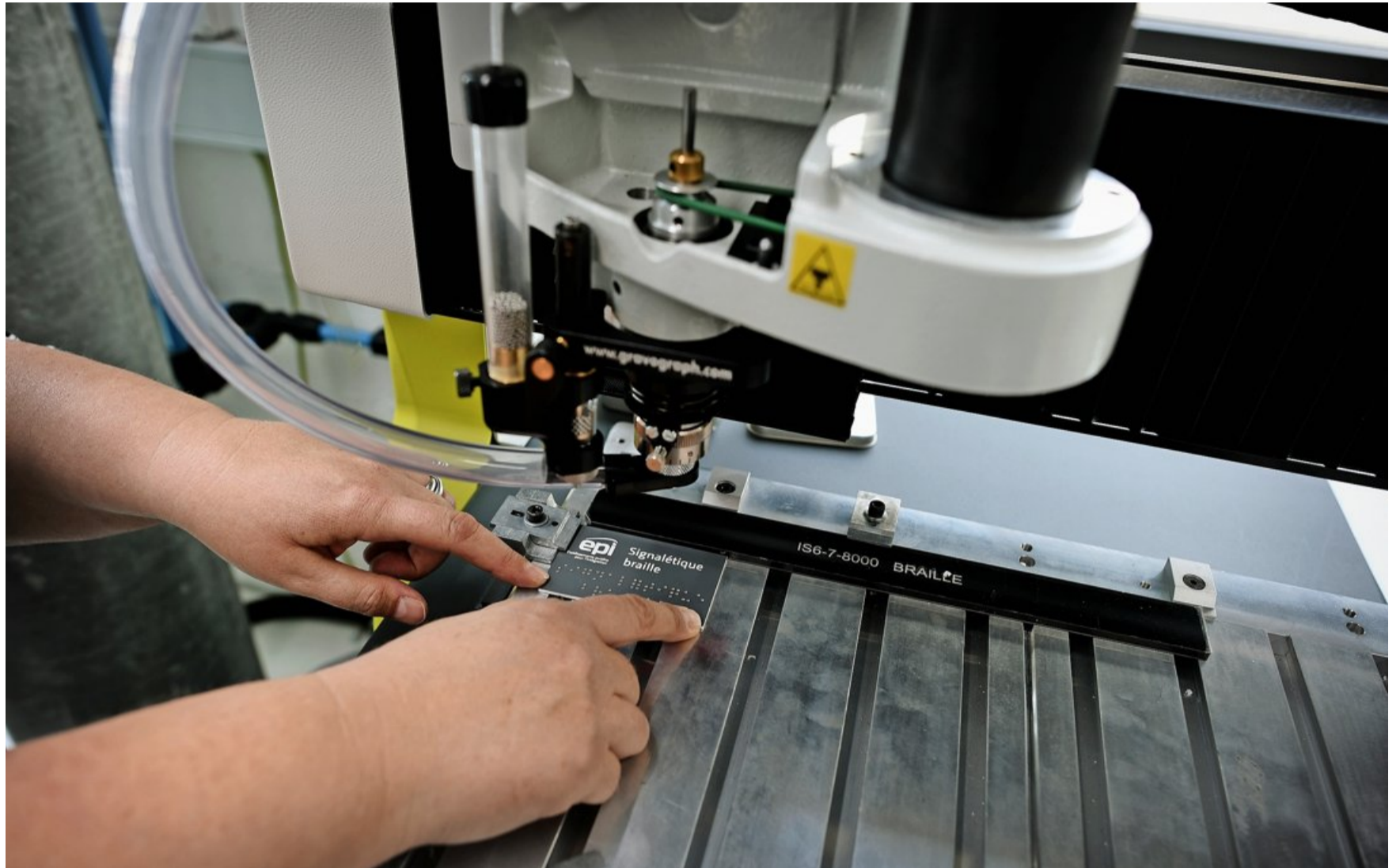
La machine sert de minuscules billes métalliques sur les supports rigides pour faire apparaître du texte en braille. LAURENT GUIRAUD
