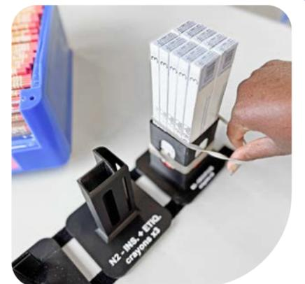
Conditionnement de 3 crayons dans une boîte et assemblage de 10 boîtes, décomposé en trois étapes réalisables avec une seule main grâce à l'outillage conçu par Jérôme Grosbéty.
